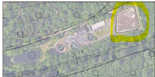
Luftbild der Kläranlage Schmitt (gelbe Markierung: Vererdungsanlage)
