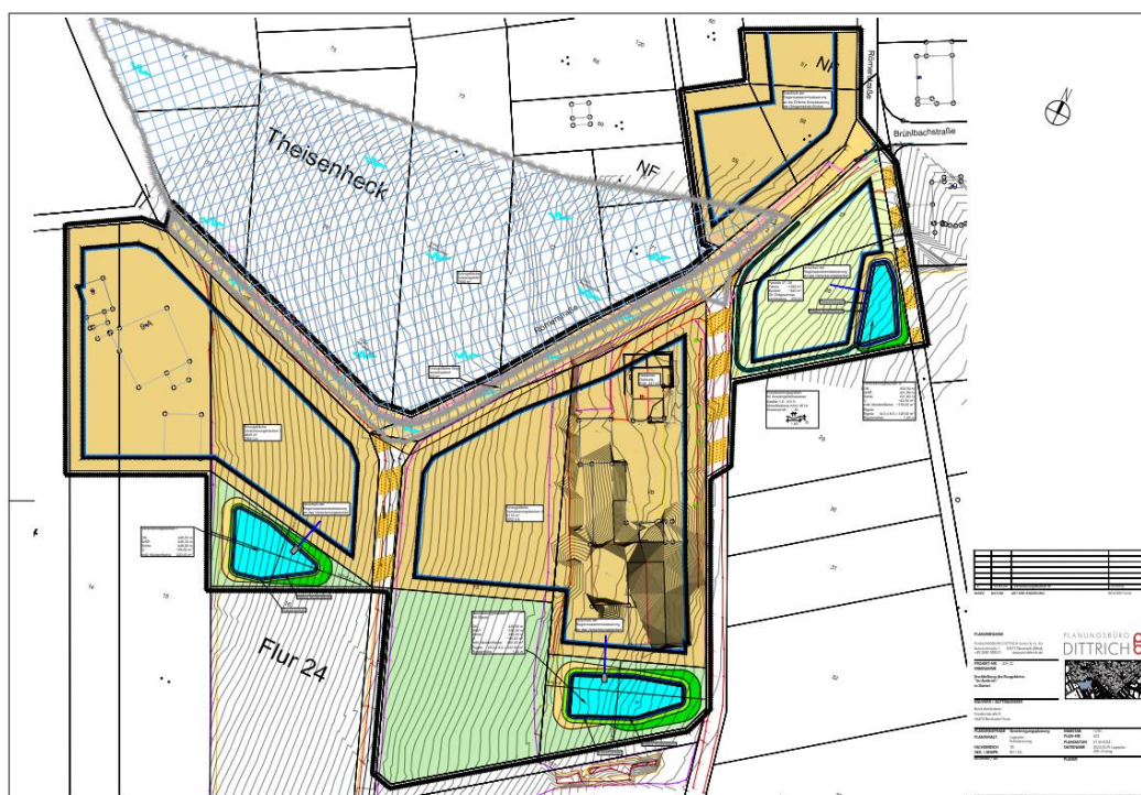
Abb. 8: Fachplanung zur Entwässerung (Stand 06.03.2024)
